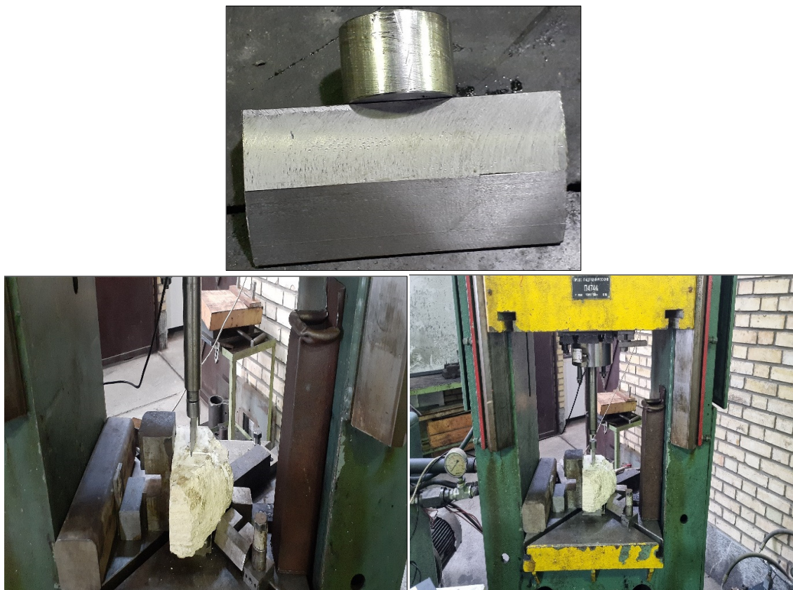
شکل ۸. تصویر قطعه گوه‌ای شکل، قرارگیری نمونه سنگ در زیر دستگاه پرس، مهار نمونه با مهارهای فولادی و اعمال نیروی قائم به آن به کمک قطعه گوه‌ای شکل
