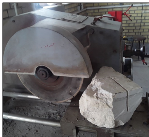
شکل ۷. نمونه سنگ تراورتن مورد آزمایش قبل و بعد از برش با دستگاه
