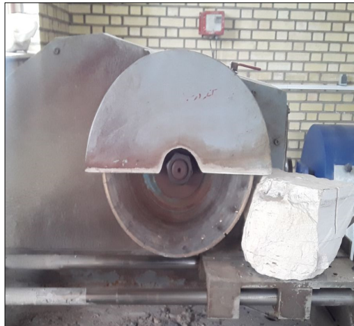
شکل ۷. نمونه سنگ تراورتن مورد آزمایش قبل و بعد از برش با دستگاه
