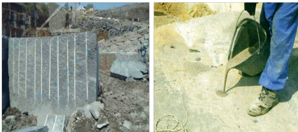
شکل ۳. پر کردن چال‌ها با پودرهای منبسط‌شونده و نمونه برش بلوک سنگ با این روش (ماربلی، ۲۰۰۴)
