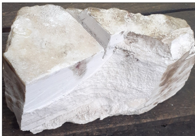
شکل ۹. تصویر سطح شکست افقی صاف یک نمونه مورد آزمایش پس از اعمال نیرو Fig. 9. Image of horizontal failure plane of a tested specimen after applying the force
