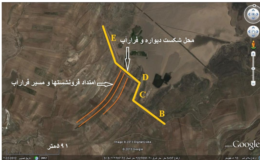
شکل ۴. موقعیت محورهای سد به همراه محل فرو نشست و مسیر فرار آب بر روی تصویر ماهواره‌ای.
