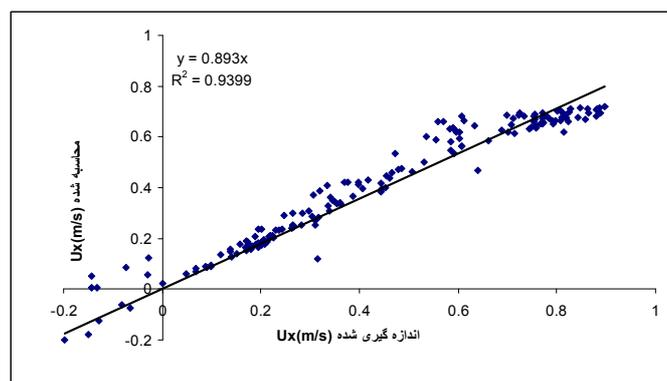
شکل ۳: مقایسه بین سرعت‌های اندازه‌گیری شده و سرعت‌های محاسبه شده در عمق ۱۱/۵ سانتی‌متر از کف
