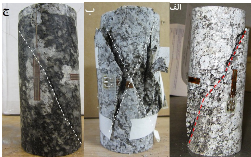
شکل ۱۱. نحوه تشکیل سطح شکست در موزوگرانیته‌ها تحت شرایط بارگذاری مختلف، الف: آزمون مقاومت فشاری تک‌محوری، ب: آزمون خستگی تک‌محوری، ج: آزمون خستگی سه‌محوری
