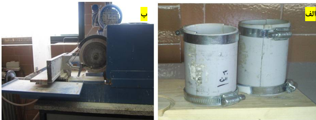
شکل ۳. الف) قالب نمونه‌های استوانه توپر، ب) دستگاه ساب و برش
