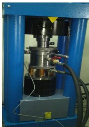
شکل ۷. سلول سه محوری بعد از متصل کردن پمپ‌ها به ورودی‌های سلول
