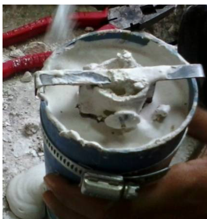
شکل ۵. قالب استوانه‌ای تو خالی بعد از ریختن گچ در قالب
