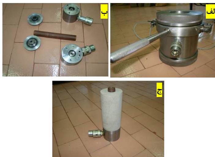
شکل ۶. الف) نمای کلی از سلول تغییر یافته هوک، ب) صفحات بارگذاری، غشای انعطاف‌پذیر و کف‌پوش‌ها، ج) غشا انعطاف‌پذیر در داخل نمونه و متصل به صفحه بارگذاری
