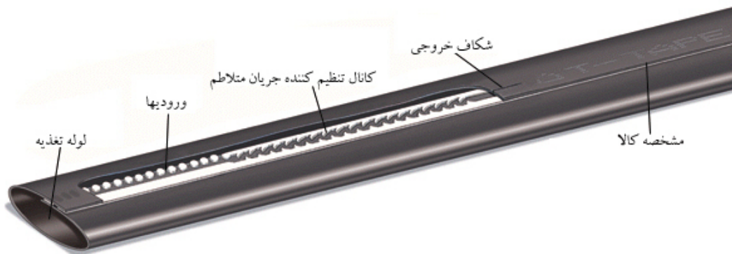
شکل ۱: لوله آبیاری قطره‌ای نواری (Tape)
