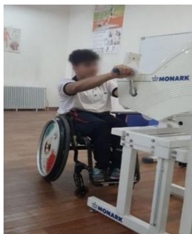
شکل ۳. نحوه استقرار برای تست وینگیت
