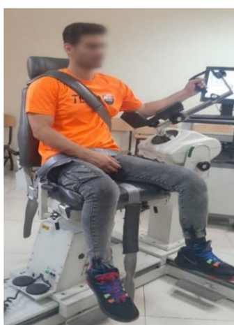
شکل ۱. نحوه استقرار برای سنجش قدرت شانه
