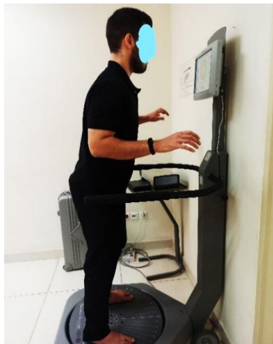
تصویر ۴: نحوه اندازه‌گیری تعادل توسط دستگاه تعادل سنج بایودکس
