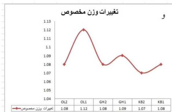
شکل ۶. نمودار درصد فراوانی پارامترهای اندازه‌گیری شده در بیتومن‌های منطقه مورد مطالعه. الف: درصد خاکستر معدنی. ب: درصد مواد فرار. ج: همبستگی منفی بین مواد فرار و خاکستر معدنی. د: درصد رطوبت. و: تغییرات وزن مخصوص نمونه‌ها.
