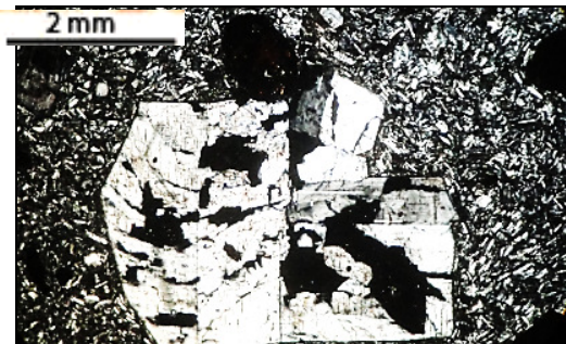
شکل ۷. تصویر میکروسکوپی مقطع نازک سنگ لاتیت کوه زنبیل دارای پلاژیوکلازهای فراوانی هست (تصویر سمت راست وضعیت نور: PPL و تصویر سمت چپ همان تصویر در وضعیت نور: XPL)
